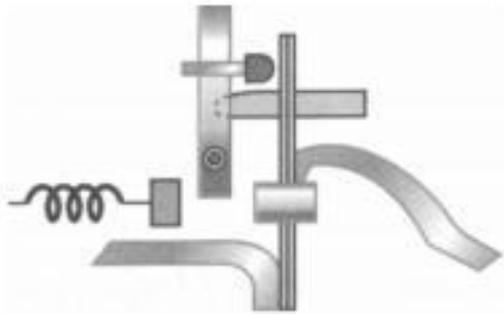
熱動電磁式正常狀況
