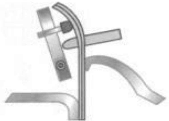
熱動式過載跳脫狀況
